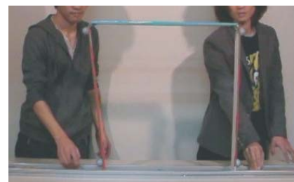
図3 協調バランスの実験 2名の棒立ての各棒の先端をリンク結合する。
